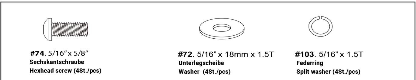
1. Befestigen Sie den Lenker mit vier Innensechskantschrauben (74), vier Unterlegscheiben (72) und vier Federringen (103).
