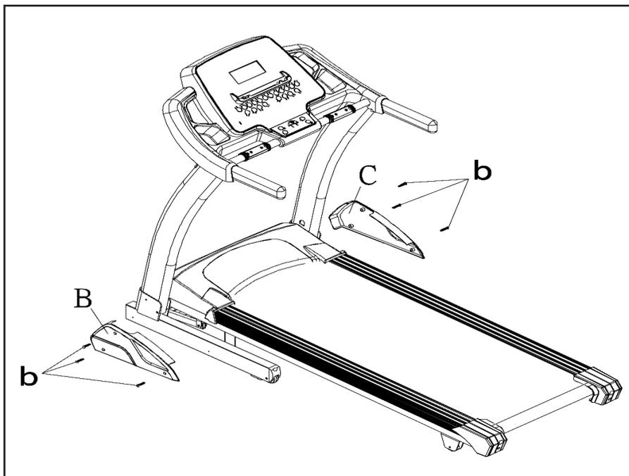
Zum Schluß montieren Sie die Abdeckungen (B) mit je drei Kreuzschlitzschrauben (b)
