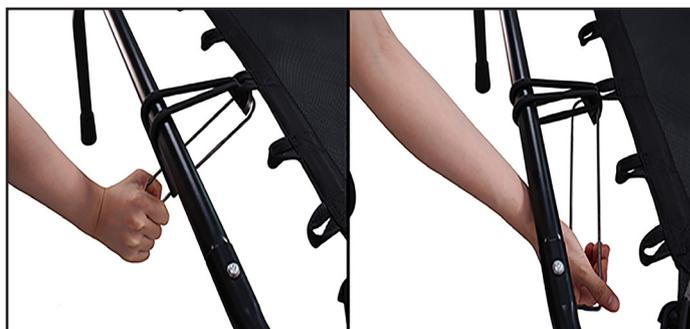
8. Klemmen Sie das Ende des Werkzeugs auf die Rückseite des Plastikhalters. Drücken Sie das Werkzeug nach unten und drehen Sie es nach innen, damit das Kabel den Halter erreicht. Ziehen Sie das Werkzeug heraus, indem Sie es einfach nach links oder rechts drehen.
